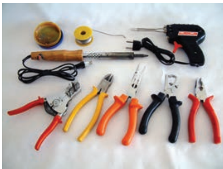
شکل ۹۱-۲- برخی ابزار کارگاه الکترونیک
