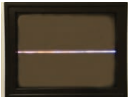
شکل ۲-۴۰- نوسان ساز عمودی از کار افتاده است.
