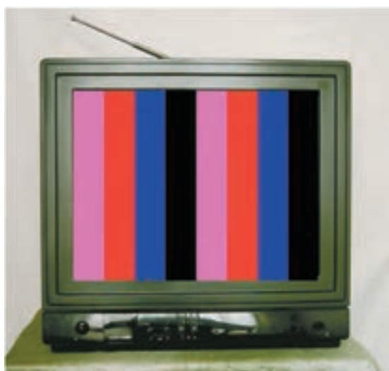
شکل ۱۳۷-۲- تصویر نوار رنگی استاندارد بدون رنگ سبز
