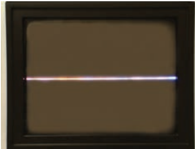
شکل ۲-۸۶- اسیلاتور عمودی از کار افتاده است.
