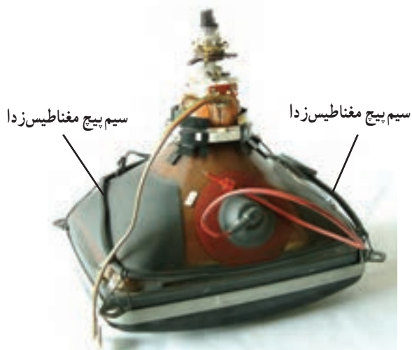
شکل ۱۰۵-۱- مدار سیستم دگوسینگ در تلویزیون گروندیک
