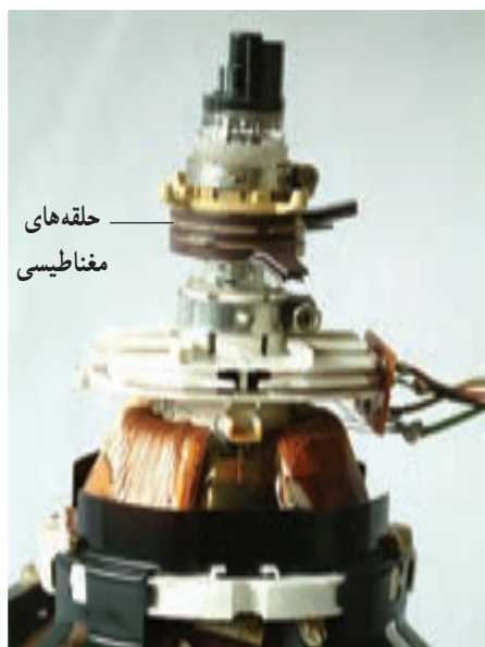
شکل ۹۸-۱- حلقه‌های مغناطیسی روی گردن لامپ
