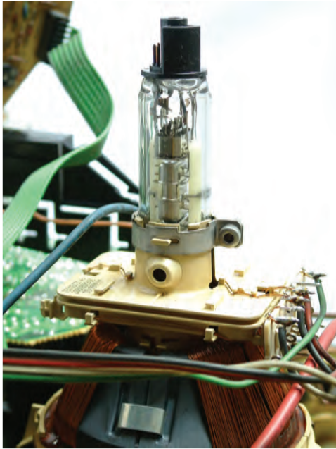
شکل ۱-۷۱ الف - شکل لامپ تصویر و پایه‌های آن
