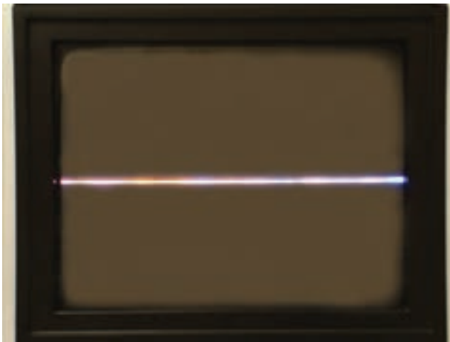
شکل ۲-۹۳- تصویر روی صفحه تلویزیون وقتی D۴۲۱ قطع است.
