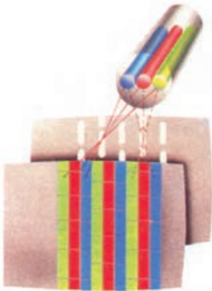
شکل ۱-۲۱- نوارهای رنگی و تفنگ الکترونی در لامپ تصویر ردیفی
