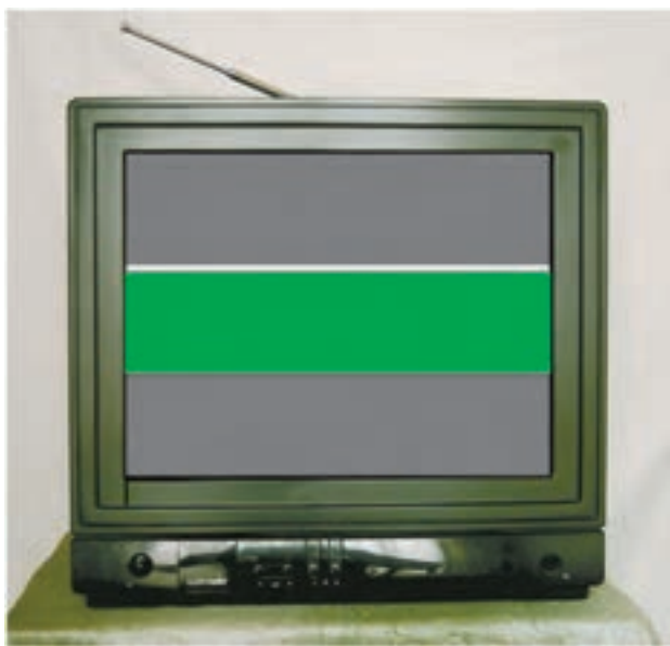
شکل ۲-۱۱۶- تصویر تلویزیون وقتی C518 قطع است.
