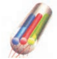
شکل ۹۳-۱- سیستم تولید اشعه In Line
