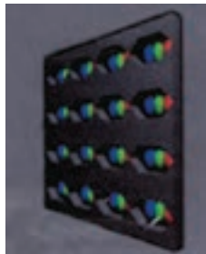
شکل ۱-۲۴- ماسک مشبک در مقیاس بزرگ‌تر
